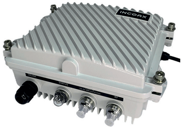
InCoax DPU D2501 (Distribution Point Unit).
